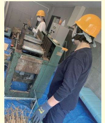
事業化がスタートし、ヨシをローラーにかけてプレスしている様子
